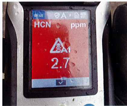
Abbildung 4: Anzeige 2,7 ppm Cyanwasserstoff (HCN) auf dem Display des Dräger Xam 8000
