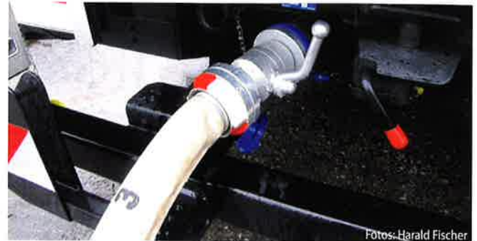
Abb. 3: Der am Tankeinfüllstutzen angebrachte Kugelhahn [5]
