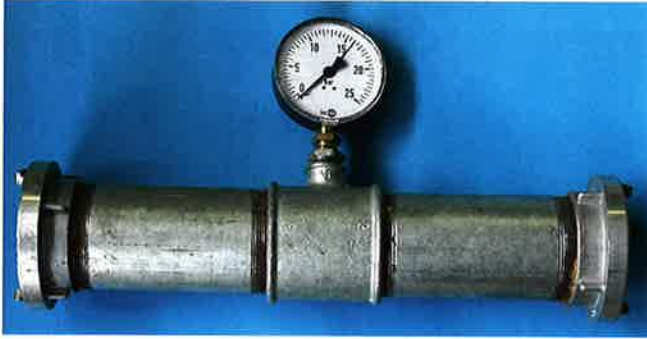
Abb. 4: Messrohr mit beidseitig angeschraubten B-Storz-Festkupplungen und Manometer in der Mitte
