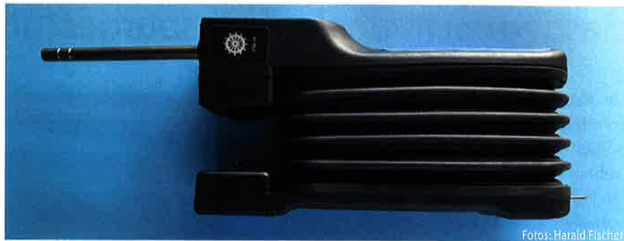
Abbildung 2: Tenax-Röhrchen mit manueller Gasspürpumpe
