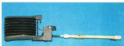
Abb. 1: Tenax® - Probenahmeröhrchen mit manueller Gasspürpumpe
